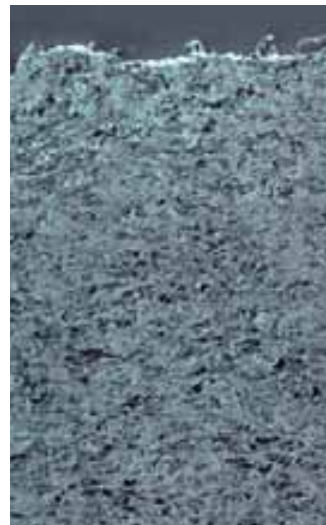
Глубинный фильтр-картон – в разрезе под микроскопом
